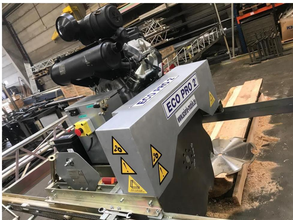
L'ECOPRO® 2-30 est équipée de rail de translation permettant de scier des grumes de 6 mètres ainsi que d'une lame de 730 mm qui peut être substitué par une lame de 630 mm à 9 dents de carbures et qui sont affûtées par l'intermédiaire d'un kit d'affûtage à meule diamantée fourni avec la machine.
